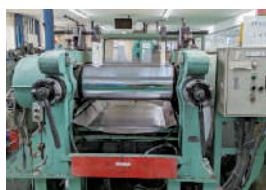
材料を混ぜるミキシングロール
